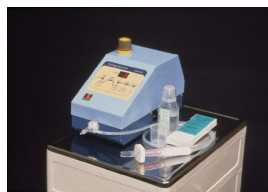
口臭検査装置（アテイン） アンモニア濃度から嫌気性菌の活動性を判断
